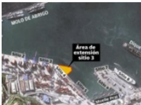
Los sitios 1, 2 y 3 concesionados por la Empresa Portuaria de Valparaíso (EPV) al Terminal Pacífico Sur (TPS) conforman un frente de atraque de 620 metros, lo que limita al Terminal 1 a atender a un solo barco de la línea post panamax, embarcaciones que tienen una eslora promedio de 333 metros y un calado de 14,5 mts.
